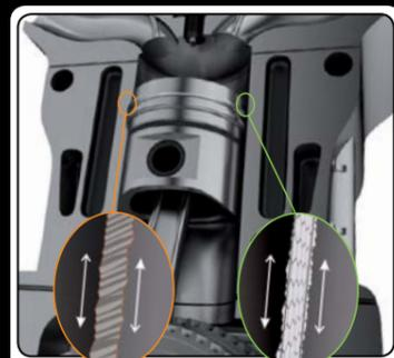
**ANTES:** Las aristas rozan entre sí y provocan la fricción, el aumento de temperatura y el desgaste de las piezas metálicas. Además pequeñas partículas de metal saltan y pueden dañar otras partes.
